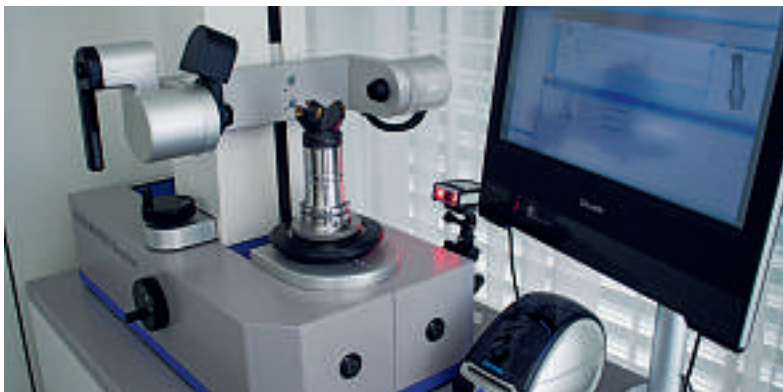
Ein mit 2D-Standscanner ausgerüstetes Werkzeugvoreinstellgerät, das die Messdaten für das entsprechende Werkzeug direkt in die Datenbank schreibt.
